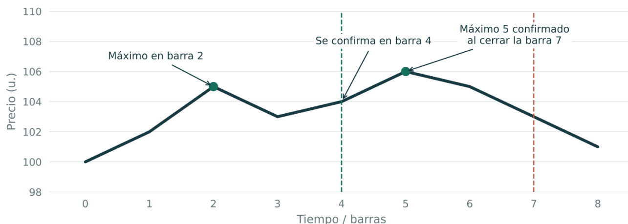
Figura 08. Localización del extremo frente al momento en que queda confirmado. La figura usa precios puntuales para simplificar. Datos sintéticos; elaboración original.
